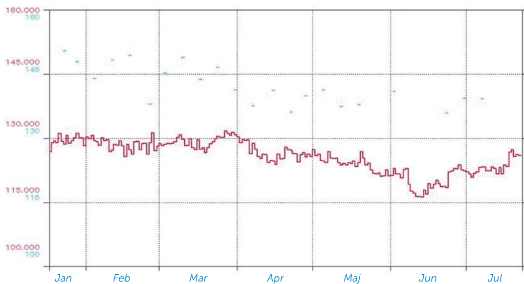
Online-analysatorns datatrend (röd) och stickprovsmätningar i laboratorium (ska divideras med 1,22)
