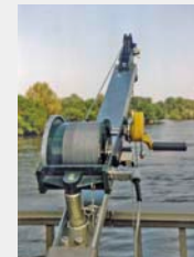
Brazo saliente para puente con cabrestante simple OTT
